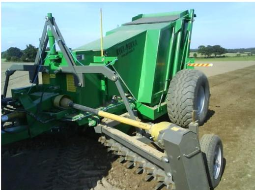
Das Gerät hat eine Arbeitsbreite von 5 Metern sowie einen ca. 1,5 cbm Steinbunker. Die große Überladehöhe ermöglicht zudem das Kippen in hohe landwirtschaftliche Anhänger.
