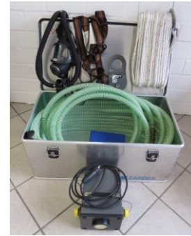
Frischluf-Druckschlauchgerät für Reparatur- und Wartungsarbeiten in Güllegruben, Silo- und Biogasanlagen
