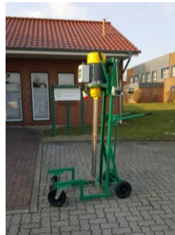
Spaltenmischer für Rinder- u. Schweinespalten Auch mit Injektorpumpe ausrüstbar
