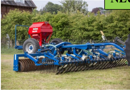
Dalbo Grünlandstriegel Maxiroll „Greenline“ 6,30m Arbeitsbreite, mit Nachsaatgerät, auch für Zwischenfrüchte geeignet
