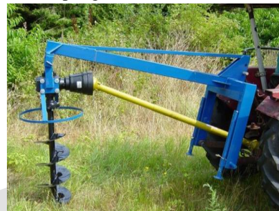
Erdbohrer für Solomiete, 20cm und 40cm Bohrerdurchmesser
